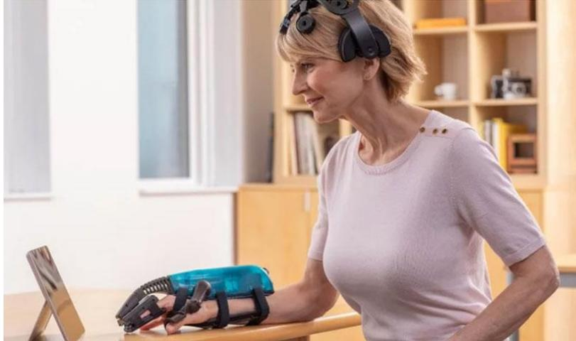
圖五、IpsiHand System 組件包含(1)穿戴在患者手上的可穿戴機器人外骨骼(Robotic Exoskeleton)、(2)平板電腦(Tablet)和(3)用擷取及紀錄腦波的生物識別耳機(Headset)<sup>[22]</sup>
